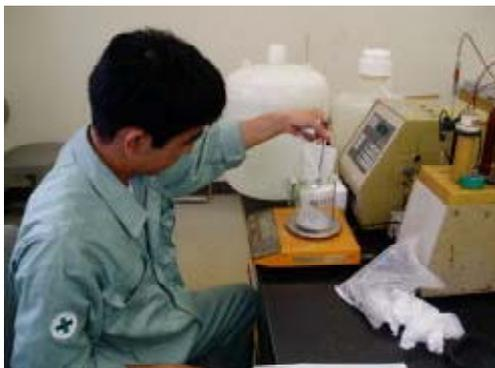
⑥硝酸溶液で軽く攪拌し煮沸5分
